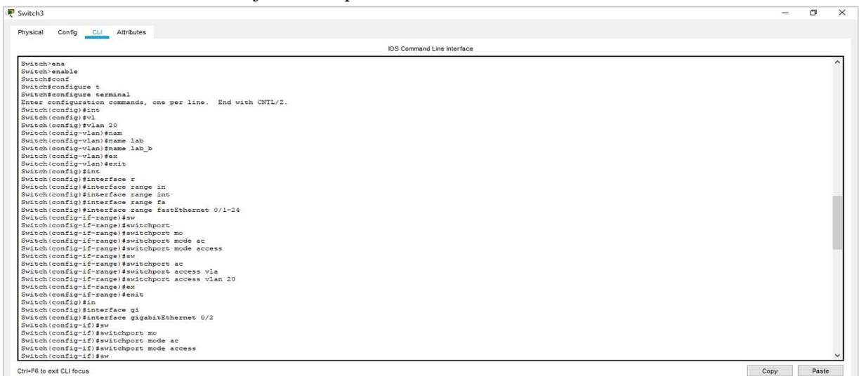
**Gambar 12. Konfigurasi VLAN20 dan Interface Switch3 Menjadi Mode Access VLAN Tertentu**
